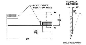
MODEL NO. DM85140 DOUBLE-END CARBIDE BIAS BLADE
